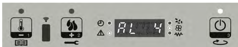
Visualizzazione messaggio che scorre sul display: AL 4 ALAR AL 4 ASPIRAT-GUASTO
