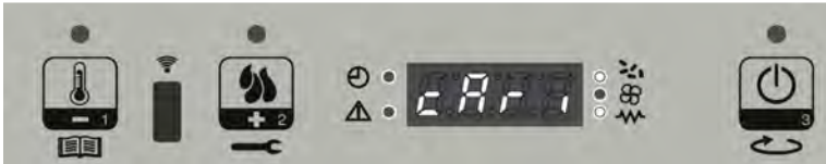
Visualizzazione messaggio che scorre sul display: CARICA PELLETTI
