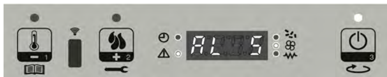
Visualizzazione messaggio che scorre sul display: AL 5 ALAR AL 5 MANCATA ACCENS-
