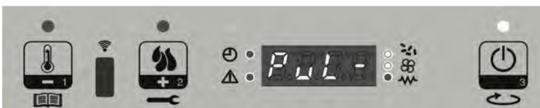
Visualizzazione messaggio che scorre sul display: PUL-BRACIERE
